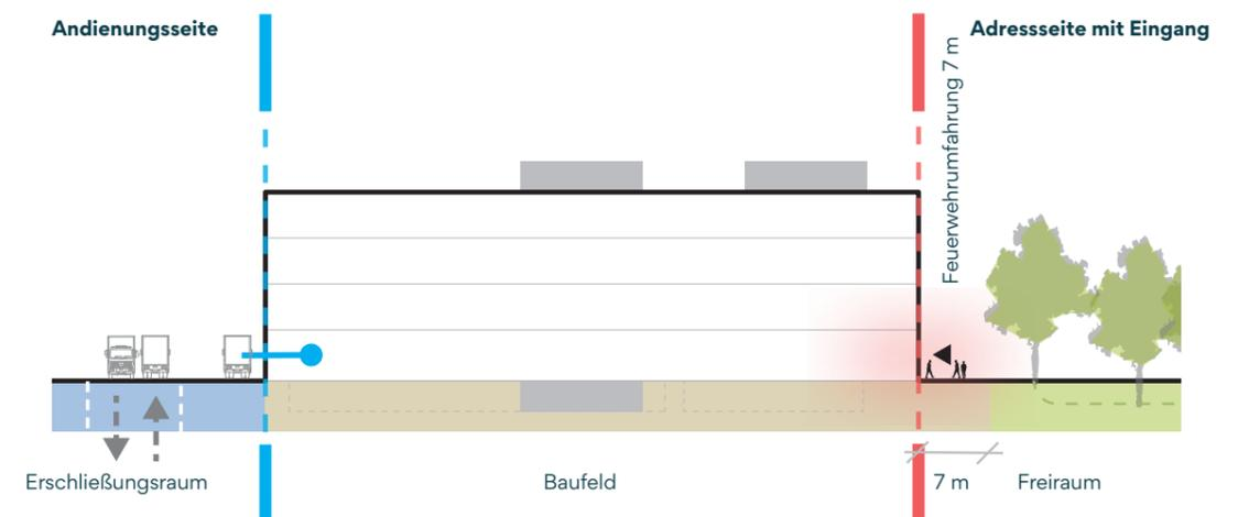
Abb. 9: Prinzipschnitt: Raumkanten, Adressbildung, Baufelder
